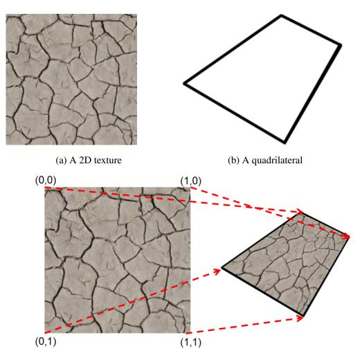
(c) Mapped quadrilateral showing mapped parameters
